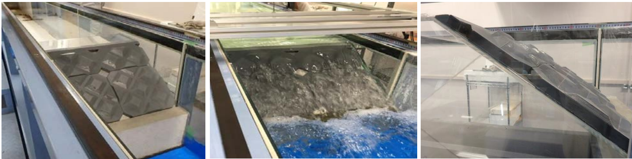
写真-15 テトラ法尻ブロック設置後および実験時の状況(テトラ法尻ブロック設置・流水時)
