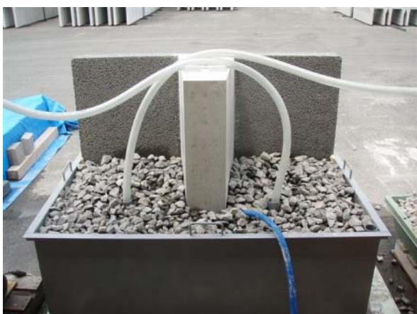
ドレーン材詰め込み状況
