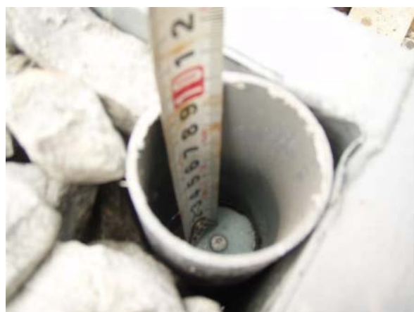
水位確認状況（槽上部より 10cm）
